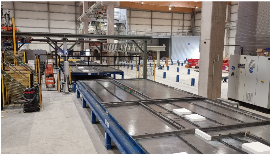
Figura 4: As peças embutidas, como soquetes e caixilhos de janelas, bem como o suplemento de reforço são ajustados manualmente.
