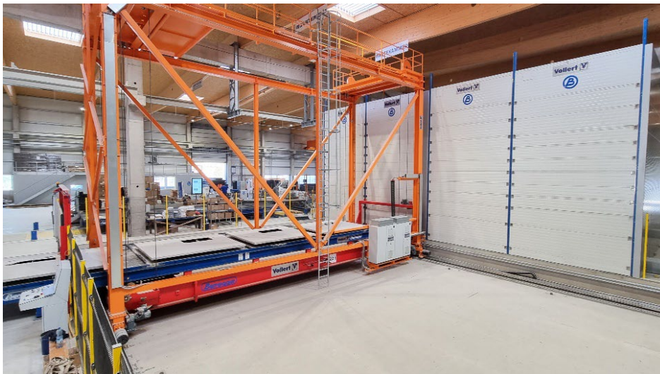
Figura 8: Uma câmara de cura VARIO CURE isolada com um sistema especial de circulação de calor garante um processo de cura com eficiência energética.
