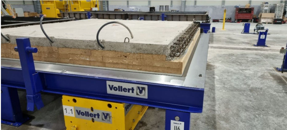
Figura 7: O isolamento das paredes em sanduíche também é inovador para reduzir a pegada ecológica.
