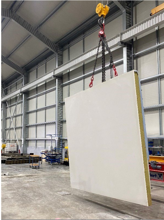
Figura 9: Deste modo, a fachada exterior em concreto de alta resistência tem apenas 25 mm de espessura.
