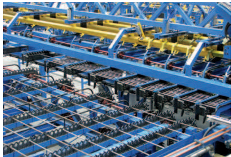
Fig. 27: Longitudinal Bar Feeding
