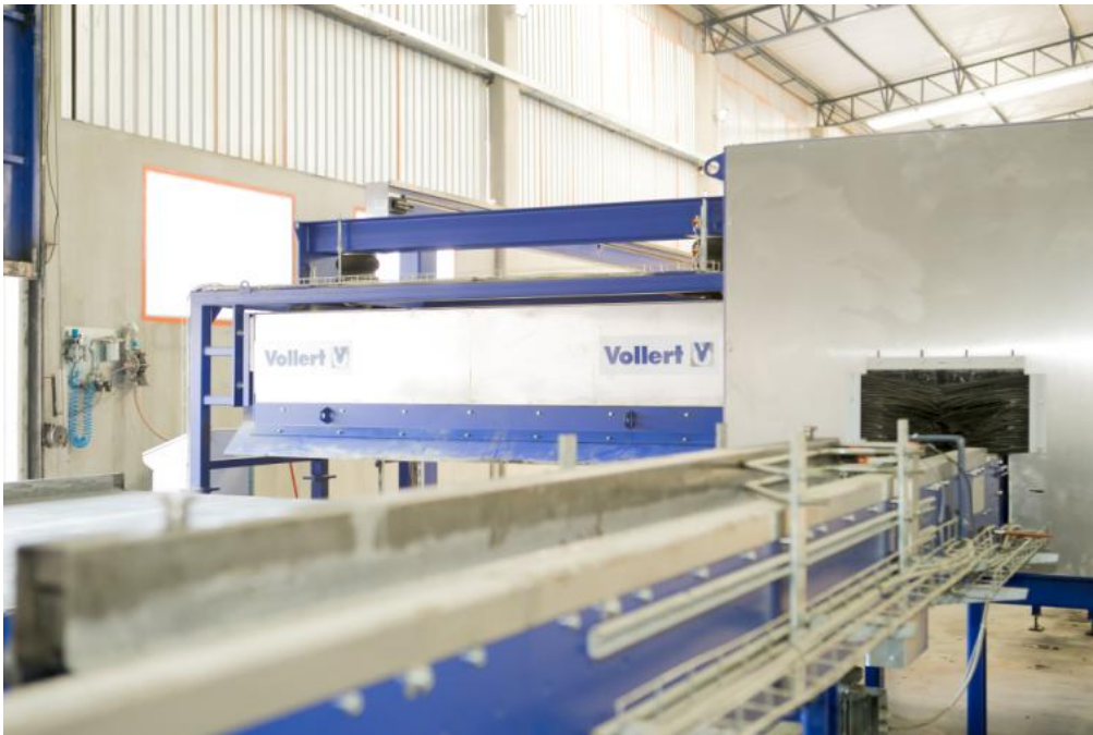
Fig. 6: 现代化清洗系统保证托板和模具剖面的清洁
