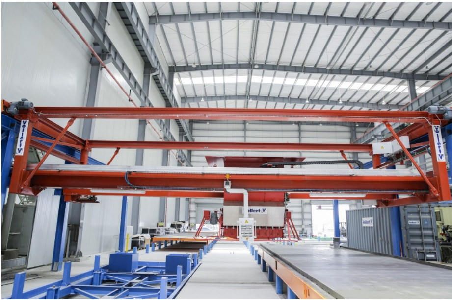
“智能铸件”(Smart Cast) 自动混凝土分布机可将混凝土精准铺用
