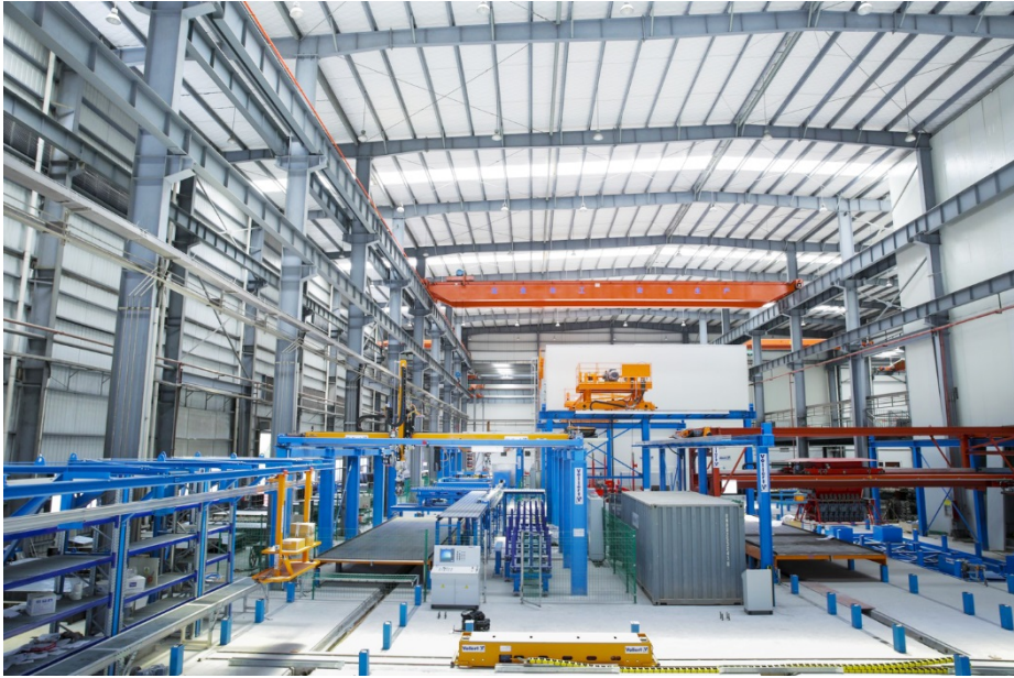
上海宝冶集团2015年引进新的预制混凝土生产线，墙体和面板原件的年产量增加80万平方米
