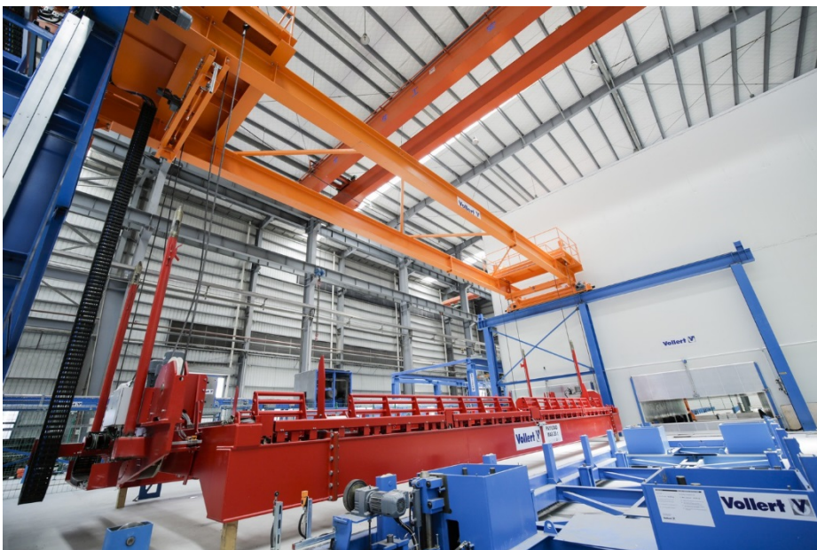
双肢墙生产过程中所使用的Vario 运货板旋转设备
