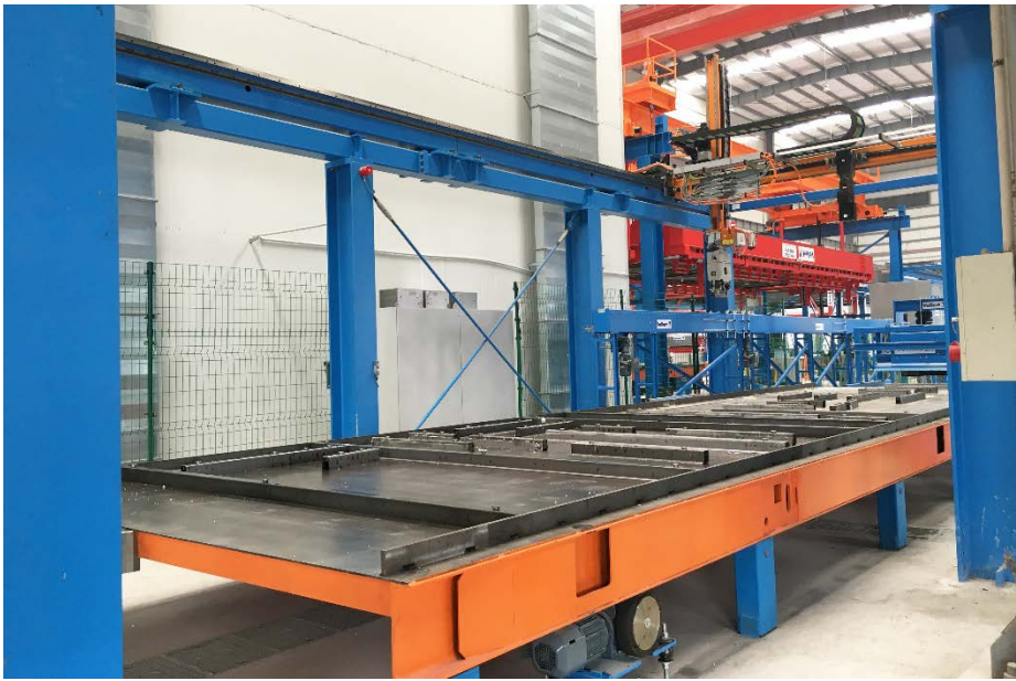
智能模板设置机器人把模板放置在CAD-/CAM-控制的全自动循环货板，货板是提前预备好的
