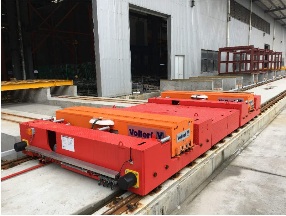
在户外智能物流货车在装载区和存储区之间运行
