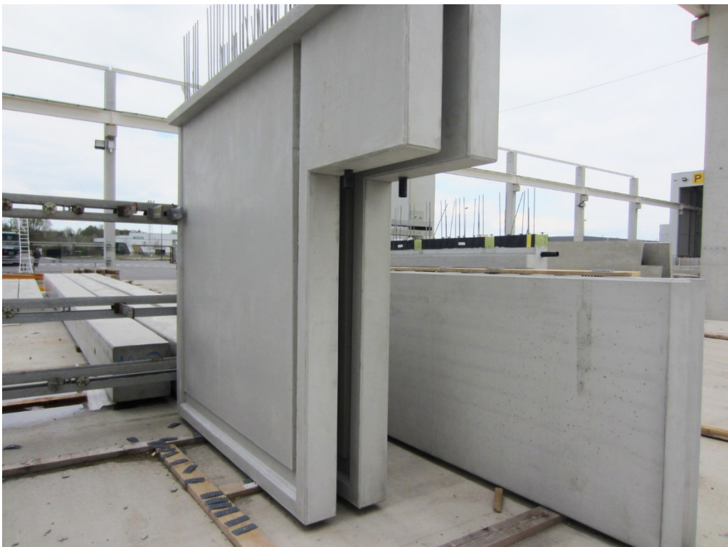
Fig. 8: Cordeel 在现代预制混凝土建筑中使用实心、双层和夹心混凝土构件
