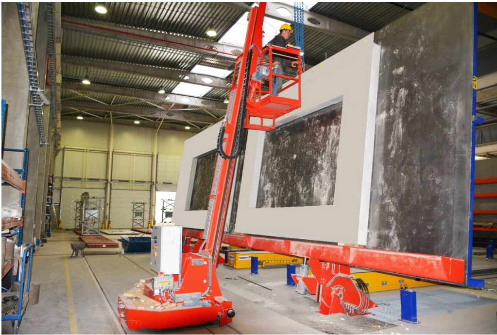
Fig. 7: 实心混凝土和半成品构件由 Vario TILT 高性能倾斜台垂直提升
