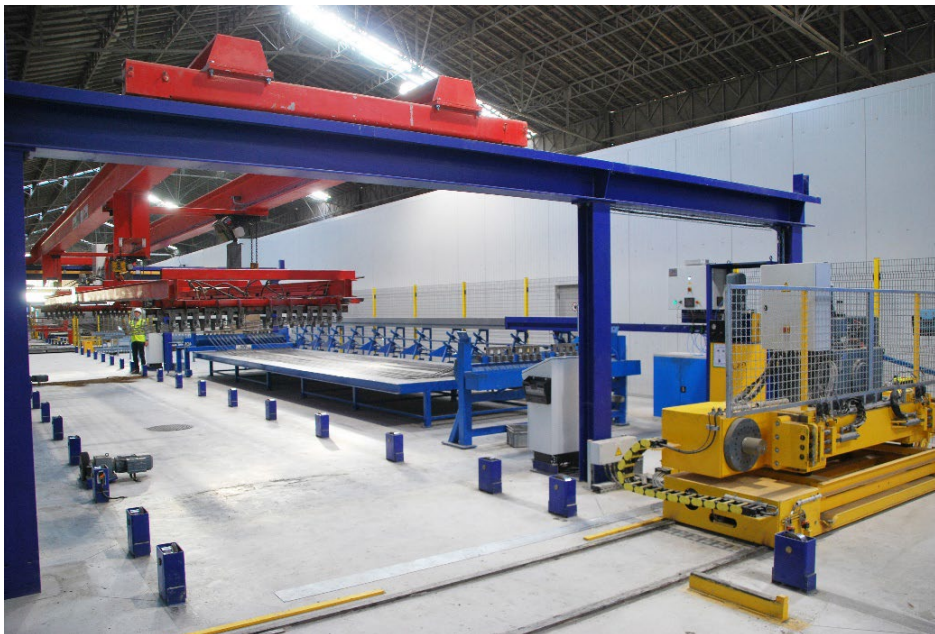
Figura 2 Después de introducir los paquetes de alambre en las formas portadoras, las abrazaderas del rastreador los alambres de acero enganchados pre.
