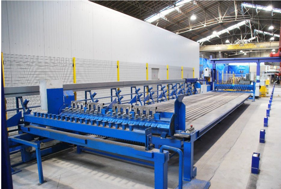
Figura 1 Antes del proceso de hormigonado, los paquetes de alambre de tensión se prefabrican con manguitos.
