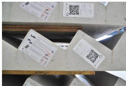
Photo 2+3: Commande mobile 4.0 - interactive et sans papier : Après un scan, les terminaux mobiles affichent les étapes de travail déjà effectuées et celles à venir.
