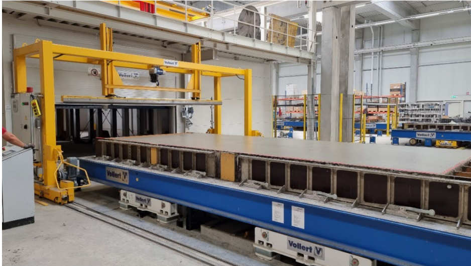
Figura 6: Una estación vibratoria SMART COMPACT garantiza una compactación óptima del hormigón tras el proceso de hormigonado.
