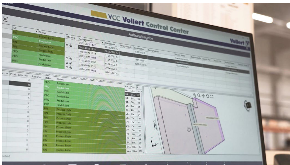
Figura 12: El Centro de Control Vollert (VCC) constituye la interfaz central para los datos creados constructivamente desde el sistema CAD o el sistema ERP y la tecnología de la máquina.
