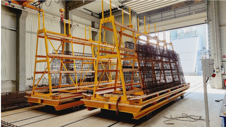
Figura 10: Los carros de transporte trasladan las mallas de refuerzo.
