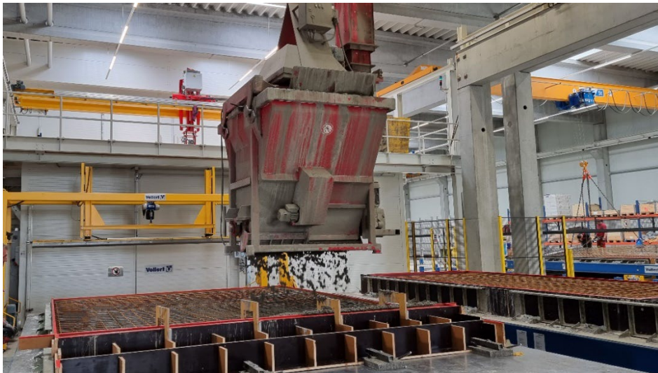
Figura 5: El cubo de hormigón existente se integró en el nuevo concepto de planta.
