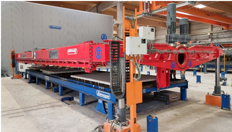
Figura 6: En la producción de doble pared, un dispositivo estacionario de giro de palets VARIO TURN garantiza un proceso de giro sencillo y semiautomático.
