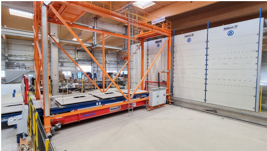
Figura 8: Una cámara de curado VARIO CURE aislada con un sistema especial de circulación del calor garantiza un proceso de curado energéticamente eficiente.
