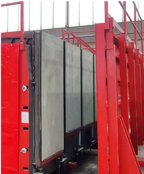
Figura 4: Para obtener una superficie de excelente calidad, los bloques de mampostería se fabrican verticalmente en suspensión.
