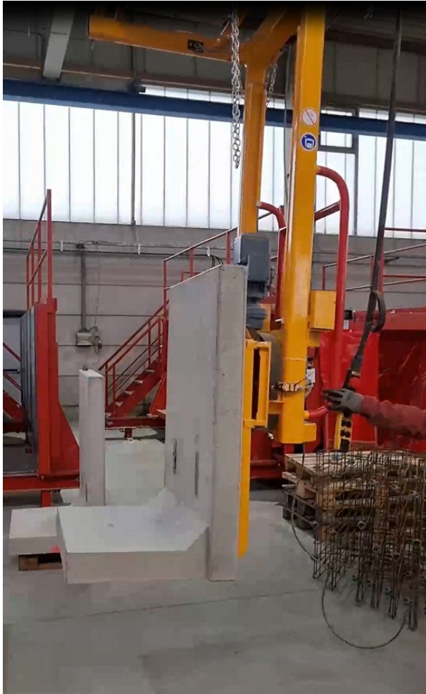
Figura 7: Una viga elevadora por vacío guiada por una grúa eleva con seguridad los bloques de mampostería en ángulo L del molde de encofrado después del desmoldeo.
