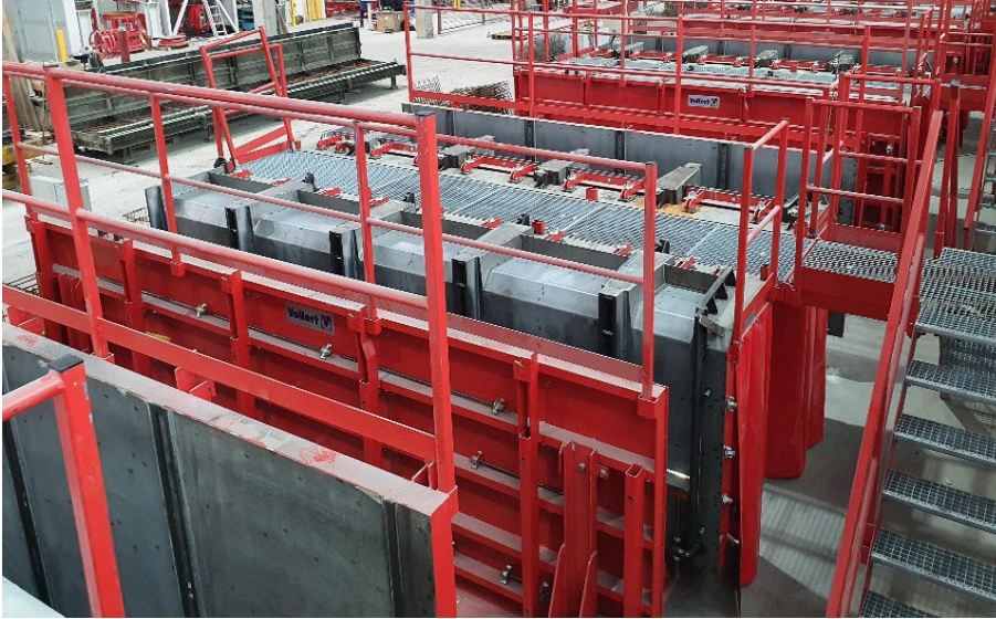
Figura 1: El encofrado en línea dúplex es una solución muy económica para la producción de bloques de mampostería.
