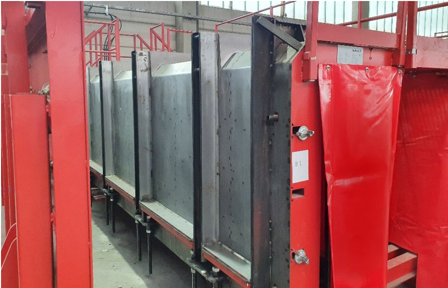
Figura 2: En cada encofrado en línea se pueden fabricar 8 elementos L con un ancho de piedra de 99 cm, así como 2 elementos L con un ancho de piedra de 49 cm cada uno.
