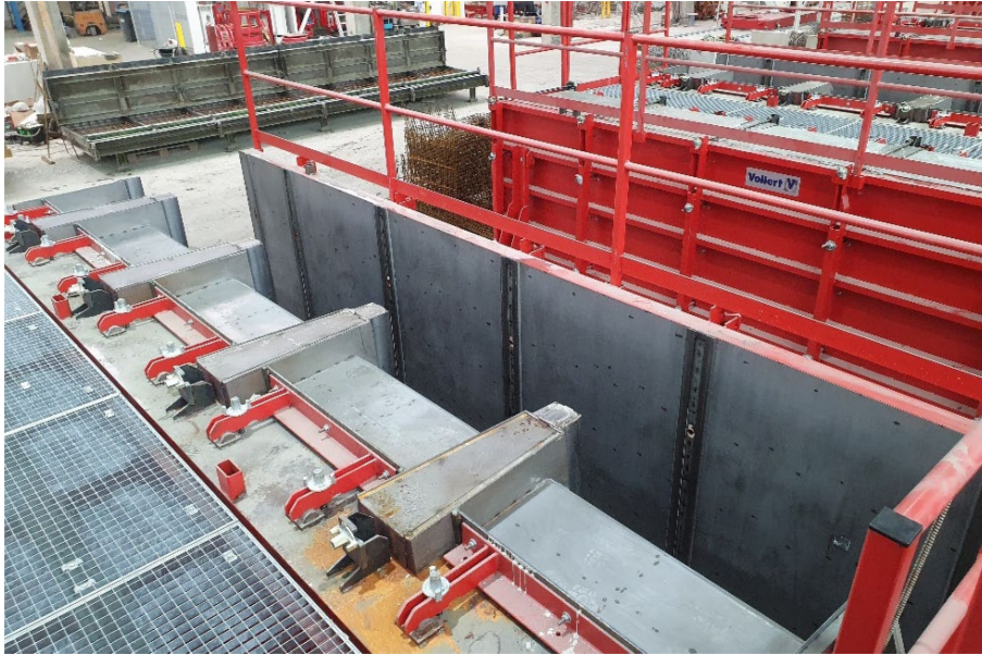
Figura 3: Los topes intermedios se dividen debido a la geometría del chaflán.
