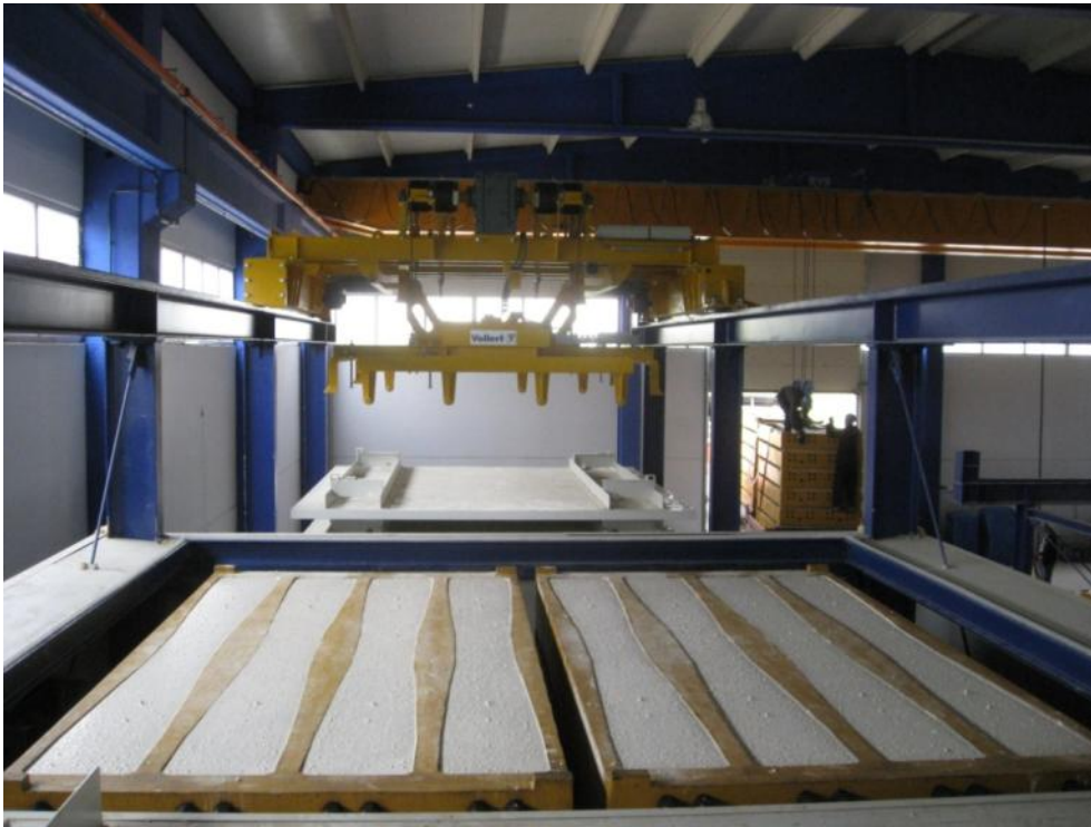
Fig 5: Manipulador de grúa para introducir y retirar los moldes de la cámara de fraguado
