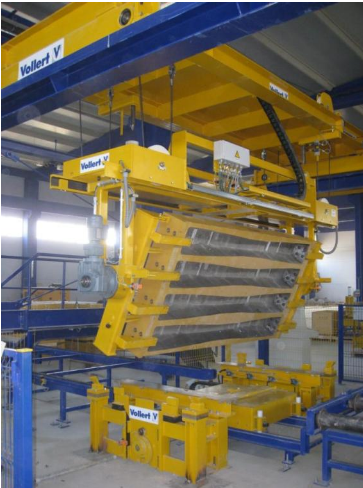
Fig 6: Los moldes se giran 180 grados con un equipo de volteo y se desencofran
