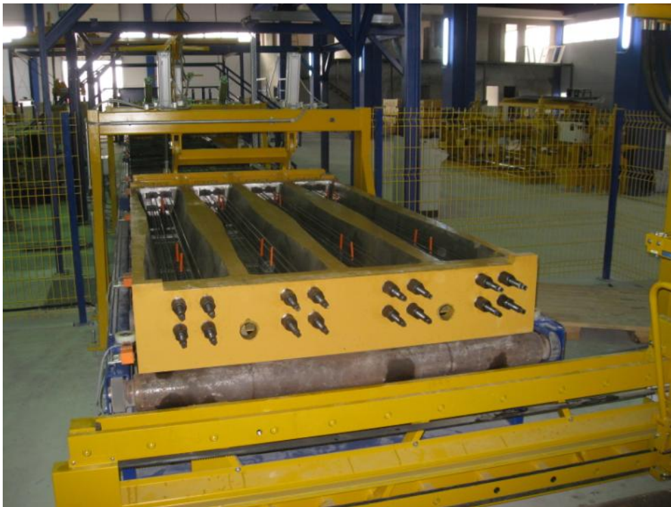
Fig 2: Molde de traviesa tras la colocación de la armadura
