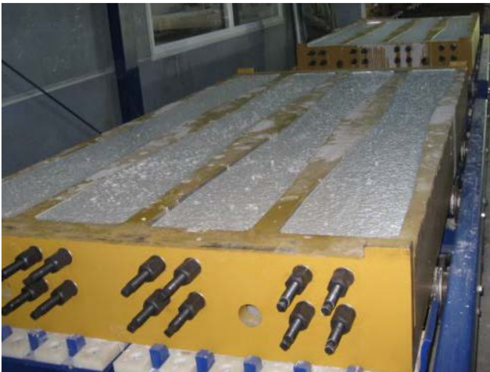
Fig 4: Moule pour traverses suite au bétonnage
