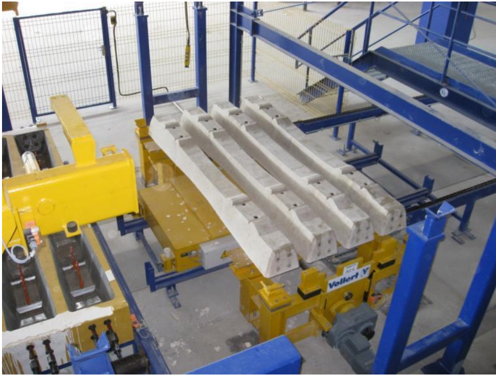
Fig 9: Traverse en béton précontraint avant le montage final
