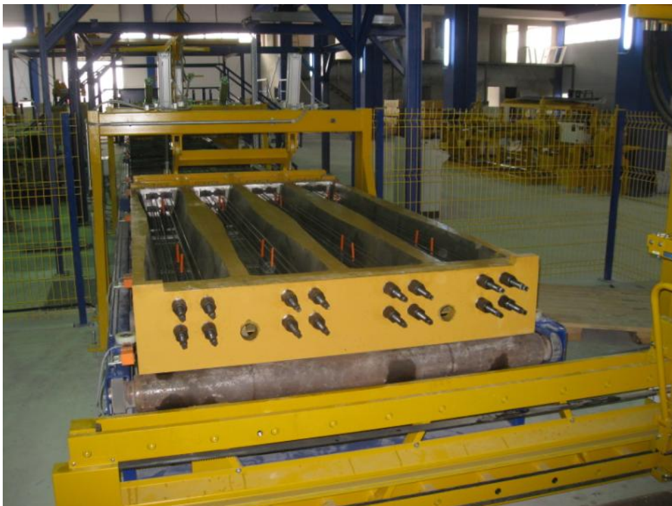
Fig 2: Moule pour traverses après la mise en place de l'armature
