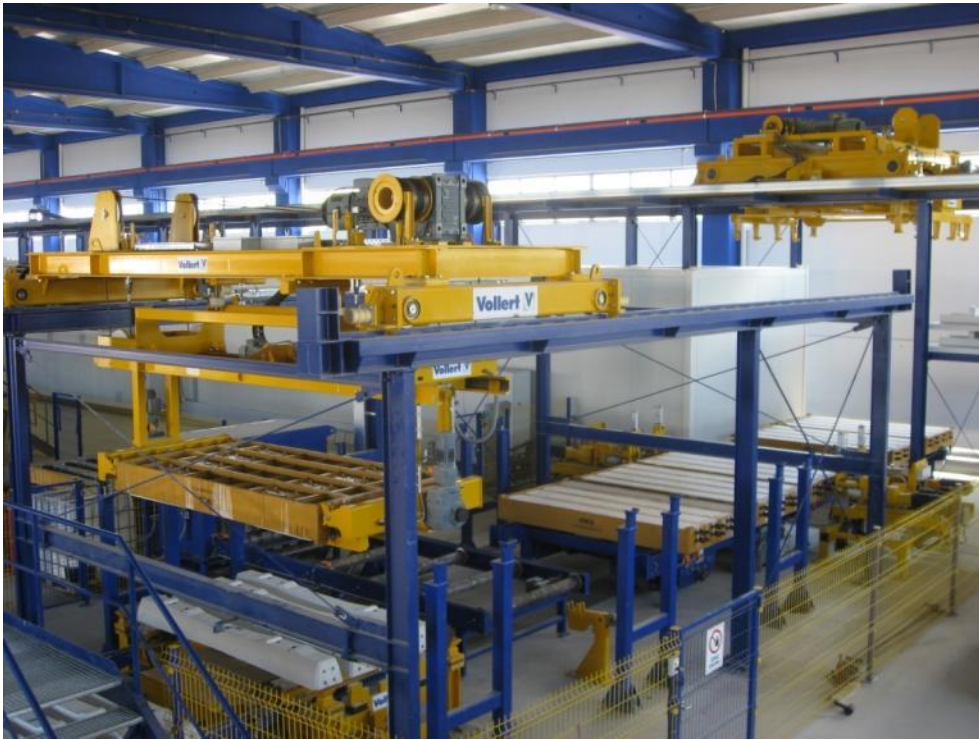
Fig 7: Processo de desmoldagem
