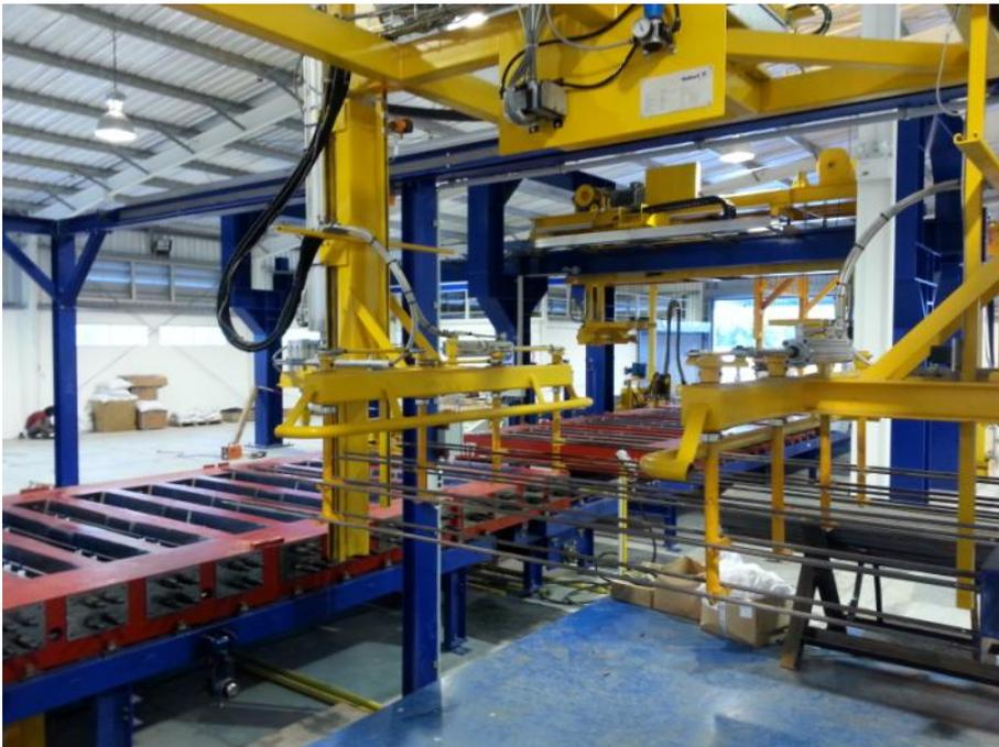
**Fig. 2:** Un manipulateur de mise en place de l'armature achemine les fils de précontrainte préparés jusque dans le moule à béton.
