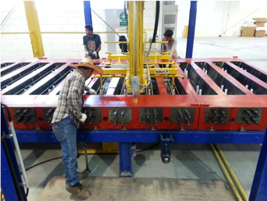
**Fig. 3:** Les différents fils sont tout d'abord fixés manuellement dans le moule à l'aide des tirants et boulons d'ancrage préalablement montés.
