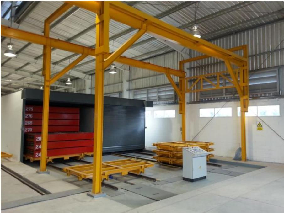
**Fig. 7:** Des temps de cycle prédéfinis permettent de déplacer les moules à béton sur les rails des chaînes de fours parallèles passant à travers le compartiment de l'étuve.
