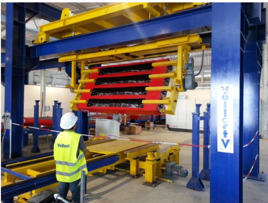
**Fig. 10:** Un palonnier de retournement achemine le moule à béton desserré vers une zone de sortie et le retourne de 180 degrés avant qu'un dispositif de levage électrique n'exécute le processus de démoulage.
