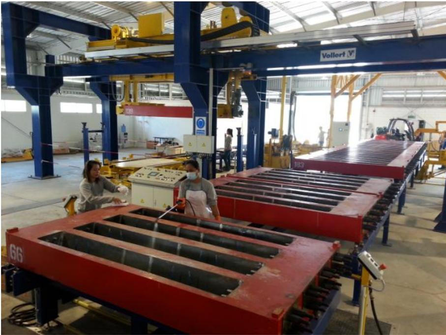
**Fig. 1:** Après le processus de démoulage, les moules pour 4 traverses sont tout d'abord huilés et nettoyés avant que les chevilles servant à la fixation ultérieure des rails ne soient mises en place.
