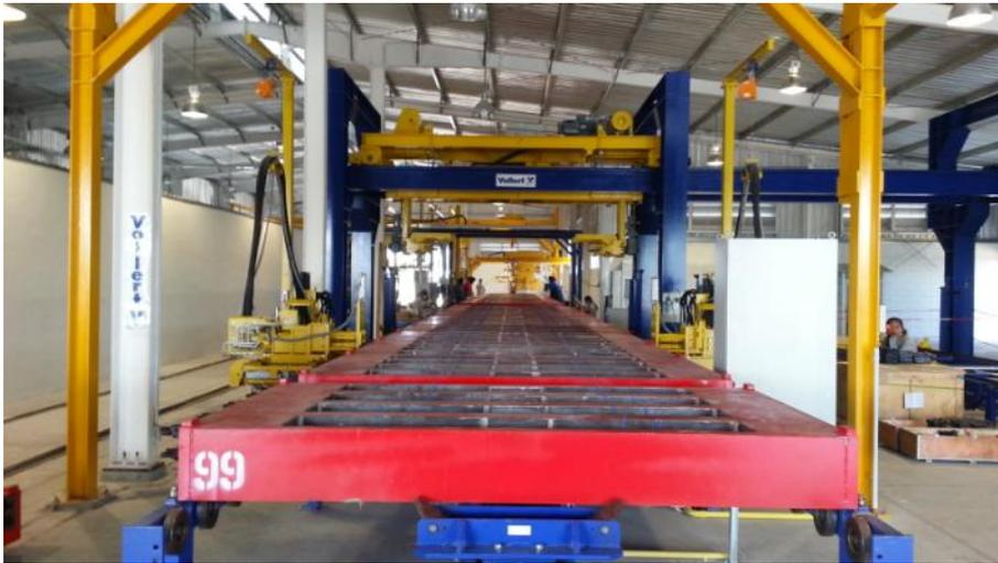
**Fig. 9:** Le processus de serrage - desserrage est ensuite amorcé par une station de détente semi-automatique.
