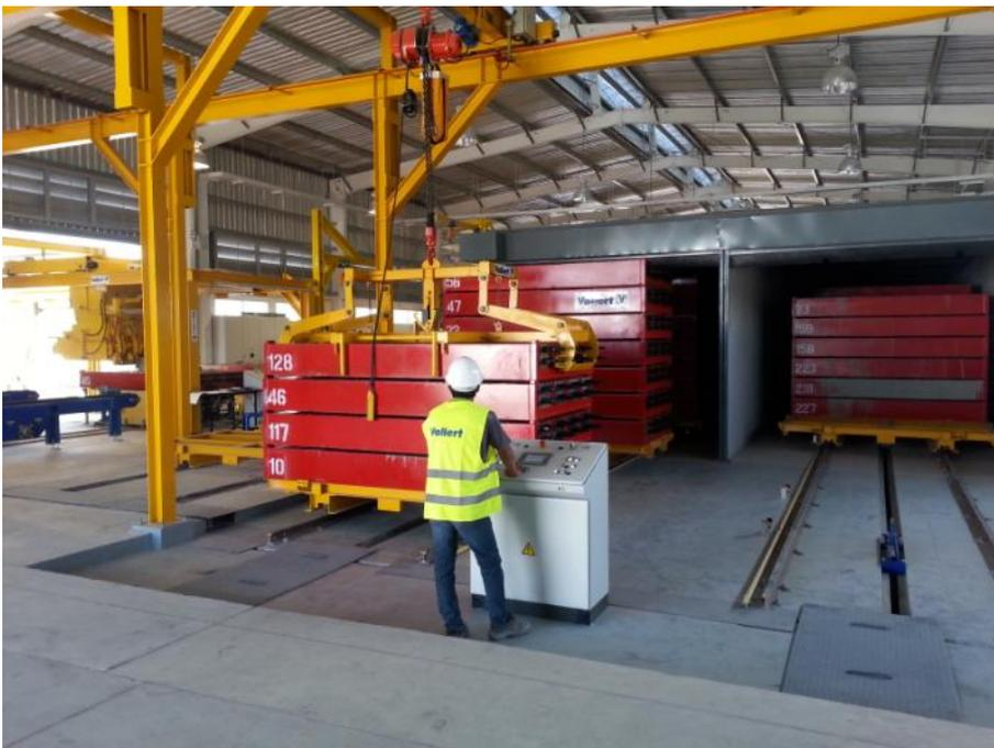
**Fig. 8:** Un palonnier spécial de levage sur la sortie de la chambre de durcissement transporte les moules à béton jusqu'à la station de détente.
