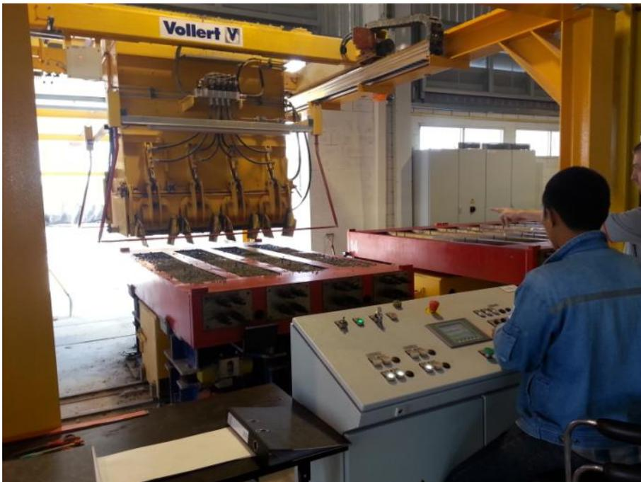
**Fig. 5:** Le distributeur de béton partiellement automatisé se déplace sur un portique entre la station de malaxage du béton à l'extérieur et la ligne de coulage.
