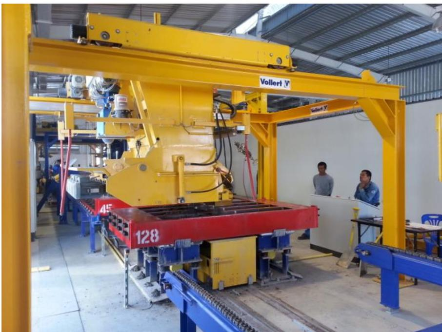
**Fig. 6:** Les vis sans fin d'évacuation à commande électrique mettent minutieusement le béton en place dans le moule immobilisé mécaniquement.
